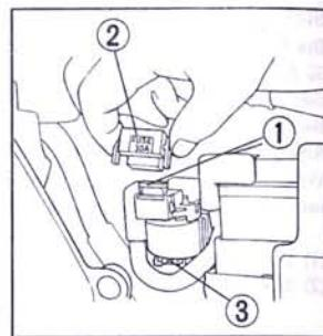
Pour remplacer le fusible principal (1), déconnecter le coupleur de fil (2) et retirer l'ancien fusible. Mettre le nouveau fusible en place, reconnecter le coupleur de fil et repasser le couvercle de la batterie.
