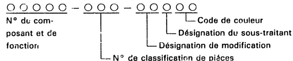
(Exemple) Boulons, écrous et autres pièces standards
